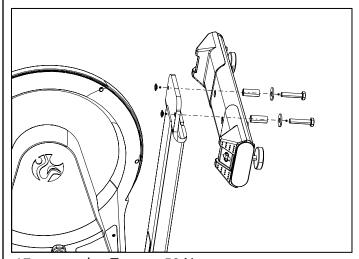
17 mm socket Torque: 50 Nm
