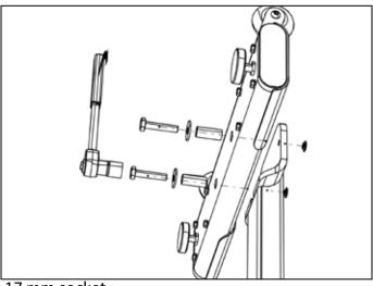
17 mm socket Torque: 50 Nm
